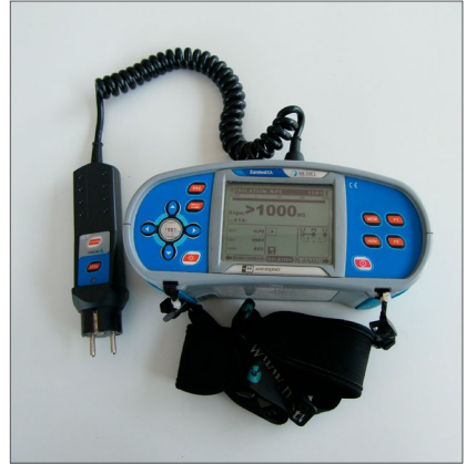
Abb. 36 Prüfgerät für Messungen an elektrischen Anlagen und Betriebsmitteln, zusätzlich: Prüfung von RCD Typ B, IT-Netzsystem, Spannungsfallmessung
