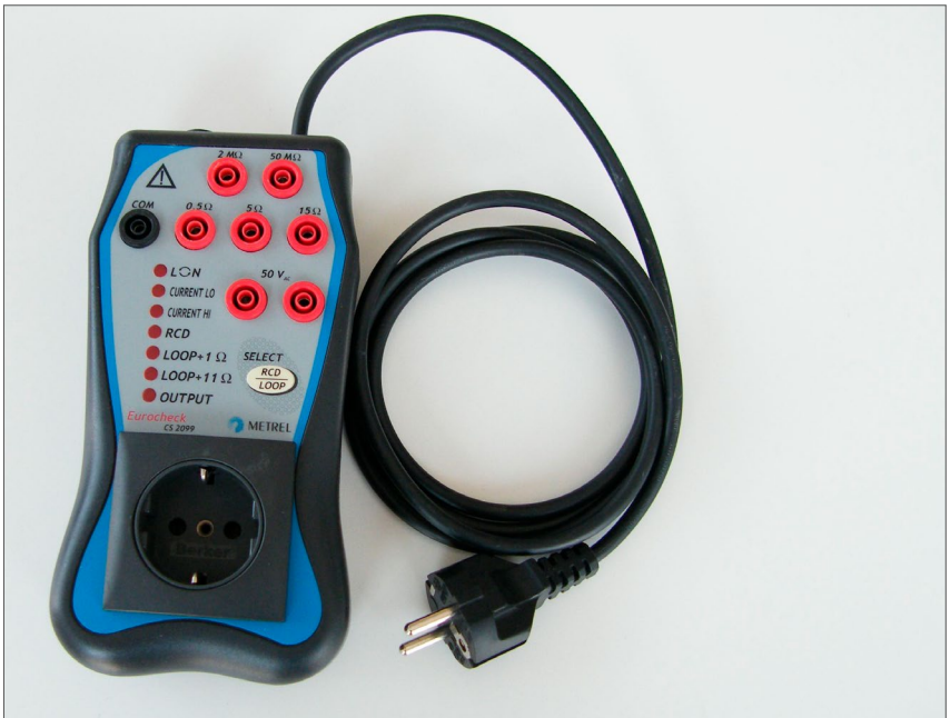
Abb. 26 Beispiel für ein Gerät zur Kontrolle der Messwertanzeigen von Prüfgeräten
