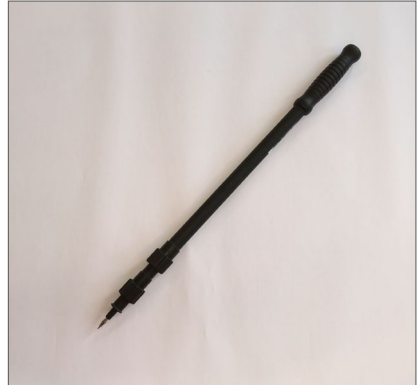
Abb. 44 Teleskopstab als Prüfspitzenverlängerung für die Schutzleiterwiderstandsmessung an Leuchten und sonstigen schwer erreichbaren Betriebsmitteln
