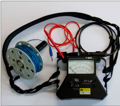
Abb. 27 Prüfgerät zur Ermittlung des Schutzleiter- und Isolationswiderstandes mit Analoganzeige und langer Messleitung auf Spindel
