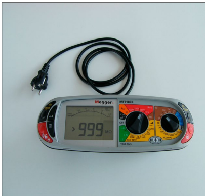
Abb. 37 Prüfgerät für Messungen an elektrischen Anlagen und Betriebsmitteln, Schutzart IP 54, Bluetooth-Schnittstelle
