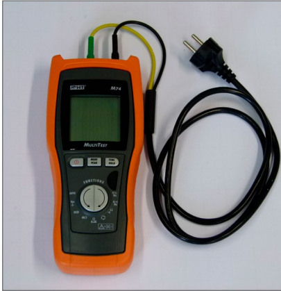
Abb. 35 Kompaktes Prüfgerät für Messungen an elektrischen Anlagen und Betriebsmitteln (ohne Speicher oder Schnittstelle)
