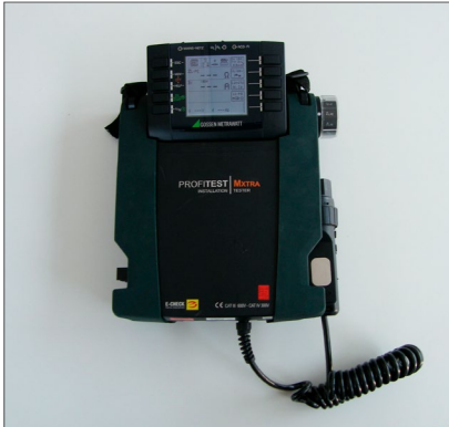
Abb. 31 Prüfgerät für Messungen an elektrischen Anlagen und Betriebsmitteln incl. IT-Netzsystem, Prüfung von Kfz-Ladesäulen, intelligente und erweiterte Speicherstruktur
