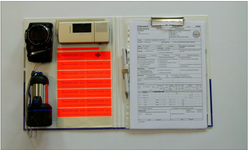
Abb. 49 Hilfestellungen für die schnelle und ordnungsgemäße Erfassung und Dokumentation (Prüfprotokoll, Schreibunterlage, Diktiergerät, Digitalkamera, Taschenlampe, Aufkleber, „Beanstandet von ...“)
