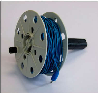
Abb. 45 Lange Messleitung auf Spindel für Schutzleiterwiderstandsmessungen
