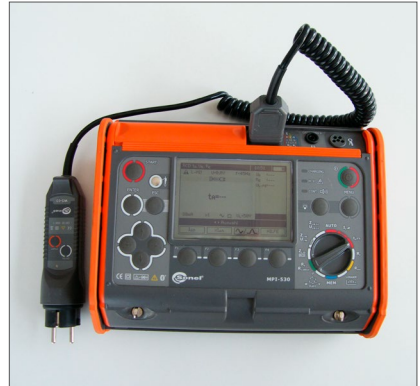
Abb. 32 Prüfgerät für Messungen an elektrischen Anlagen und Betriebsmitteln, Gehäuseschutzart IP 54, zusätzliche Prüfung von RCD Typ B
