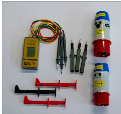
Abb. 42 Drehfeldprüfgerät, Prüfspitzen und Prüfadapter für Drehstrom-Anschlüsse
