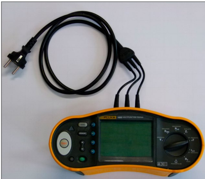
Abb. 29 Prüfgerät für Messungen an elektrischen Anlagen und Betriebsmitteln
