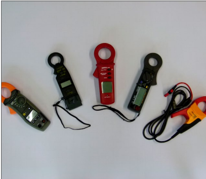
Abb. 39 Strommesszangen („Zangenamperemeter“); Einzelgeräte und Adapter
