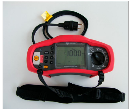
Abb. 30 Prüfgerät für Messungen an elektrischen Anlagen und Betriebsmitteln
