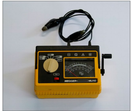
Abb. 28 Prüfgerät zur Ermittlung des Schutzleiter- und Isolationswiderstandes mit Analoganzeige. Prüfspannung wird über Drehkurbel erzeugt.
