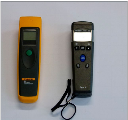
Abb. 48 IR-Thermometer für berührungslose Temperaturmessungen
