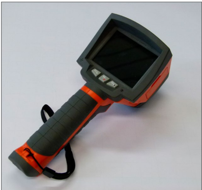
Abb. 47 Thermographiekamera für die schnelle und zielgerichtete Detektion von Wärmequellen
